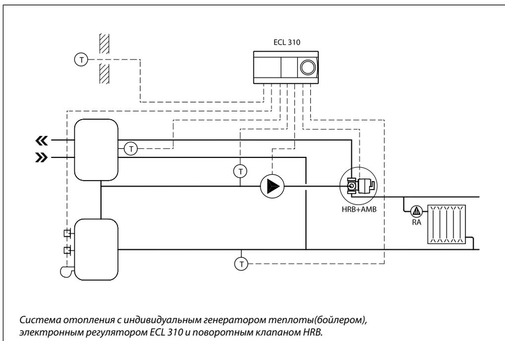
Схема электрических соединений
