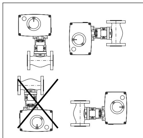
Электропривод может быть повернут вокруг оси штока клапана в удобное для обслуживания положение (на 360°), после чего зафиксирован на клапане стопорными винтами.
