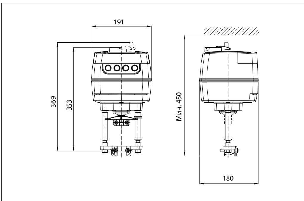
Комбинации электроприводов и регулирующих клапанов
