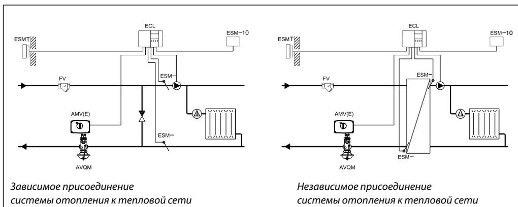
Установка клапана на подающем трубопроводе
