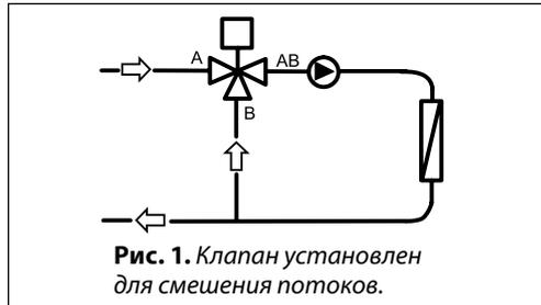
**Рис. 1.** Клапан установлен для смешения потоков.
