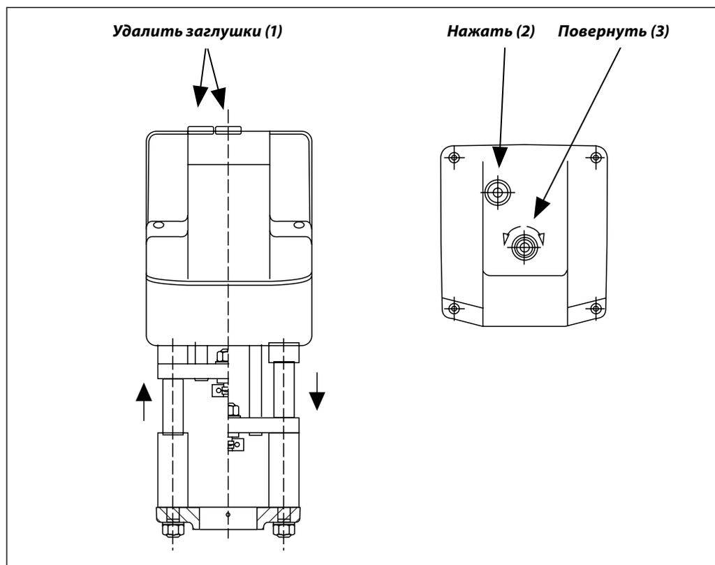
Ручное позиционирование производится с помощью 8-мм шестигранного торцевого ключа (в комплект поставки не входит) поворотом его до нужного положения. При этом следует проверить правильность направления вращения шпинделя. Позиционирование выполняется в следующей последовательности:
