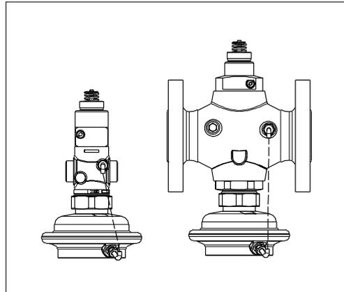
AVQM является комбинацией седельного регулирующего клапана (исполнительного механизма электрической системы регулирования) и автоматического регулятора – ограничителя расхода прямого действия с диафрагмой и рабочей пружиной. AVQM используется совместно с электроприводами типа AMV150\*, AMV(E) 10\*, AMV(E) 13\*, AMV(E) 13SU\*, AMV(E) 20, AMV 20SL, AMV(E) 23,
