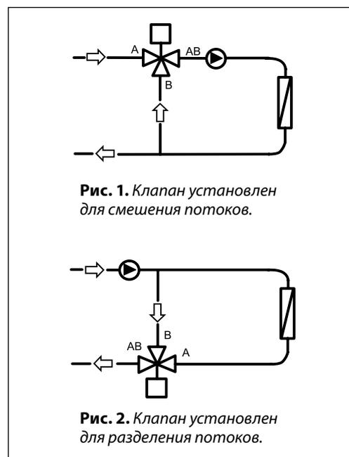
**Рис. 1.** Клапан установлен для смешения потоков.
