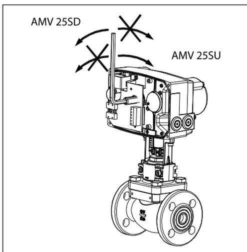
Ручное позиционирование производится при отключенном напряжении и снятой крышке привода. Для позиционирования следует вставить 5-мм шестигранный торцевой ключ (не входит в комплект поставки) в верхнюю часть шпинделя привода и поворачивать его, преодолевая сопротивление пружины и следя за направлением перемещения штока. Чтобы удержать положение штока при ручном позиционировании, необходимо зафиксировать ключ.
