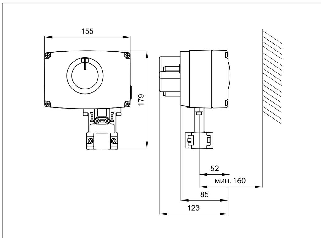
Комбинации электроприводов и регулирующих клапанов
