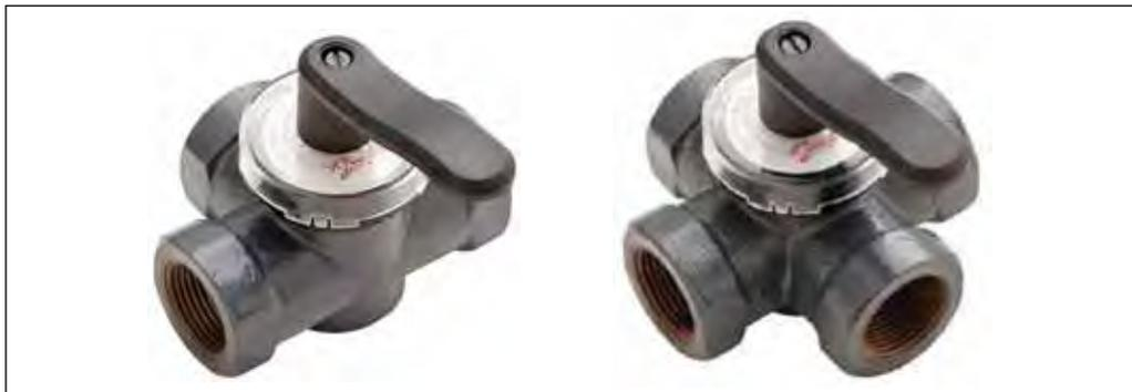
Клапаны регулирующие поворотные серии HRE предназначены для применения в системах теплоснабжения, где допускается некоторая протечка теплоносителя через закрытый клапан, и нет необходимости в обеспечении точных характеристик регулирования. Клапаны HRE можно использовать совместно с редукторными электрическими приводами AMB 162 или AMB 182.
