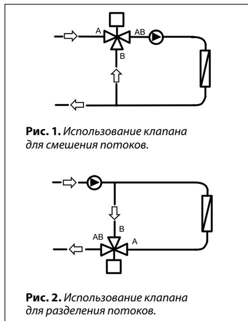
**Рис. 1.** Использование клапана для смешения потоков.
