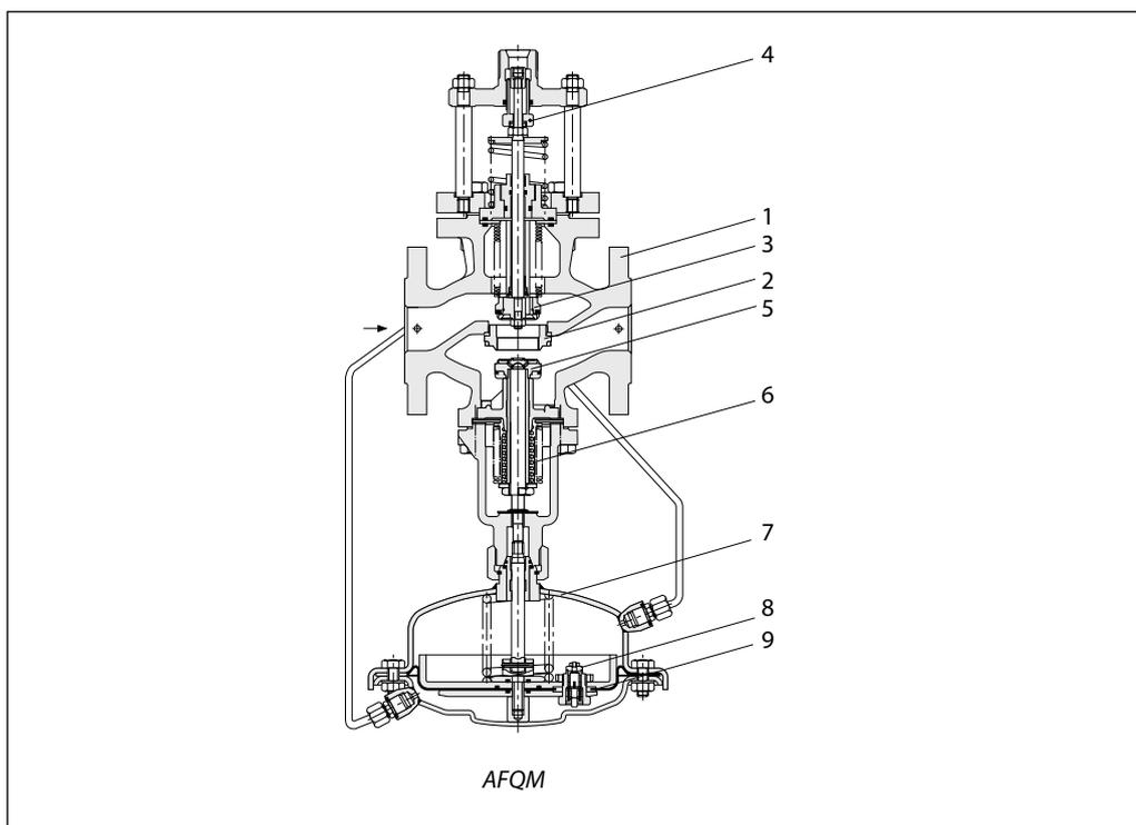
Регулятор работает как ограничитель расхода, а также как регулирующий клапан. Блок, регулирующий давление, удерживает на клапане постоянный перепад давлений 0,2 бар.
