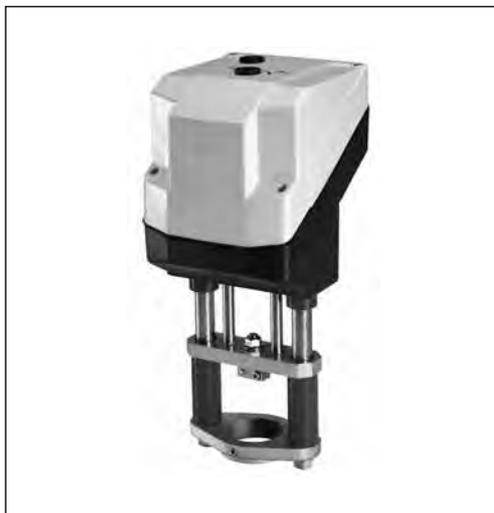
Электроприводы AME 85 и AME 86 предназначены для управления регулирующими клапанами VFS2  $D_y = 65-100$  мм и VF3  $D_y = 125-150$  мм. Электропривод автоматически настраивается на крайние положения штока клапана.
