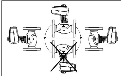
Перед монтажом клапана трубопроводная система должна быть промыта, соединительные элементы трубопровода и клапана размещены на одной оси, клапан защищен от напряжений со стороны трубопровода. При монтаже клапана необходимо убедиться, чтобы направление движения регулируемой среды совпадало с направлением, указанным на его корпусе: всегда от входа А (у проходных клапанов) или от входов А и В (для трехходовых клапанов) к выходу АВ.
