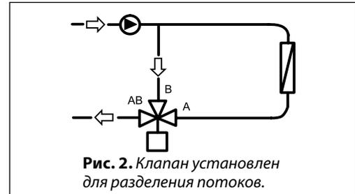
**Рис. 2.** Клапан установлен для разделения потоков.
