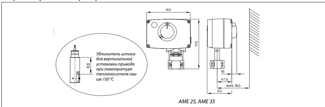
Комбинации электроприводов и регулирующих клапанов
