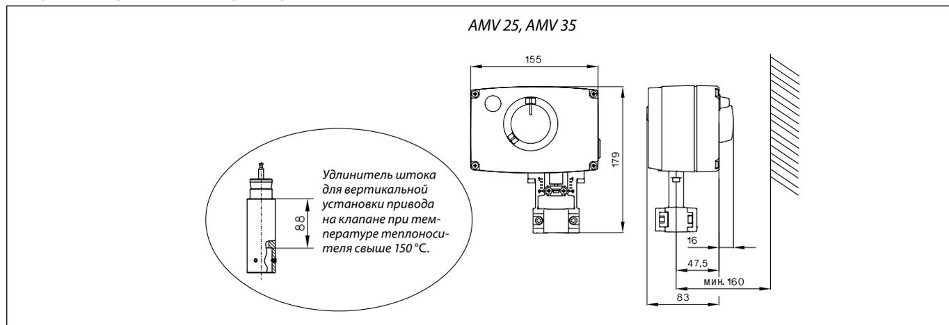
Комбинации электроприводов и регулирующего клапана
