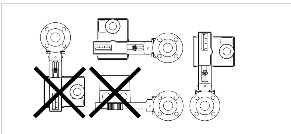
Комбинации электроприводов и регулирующих клапанов
