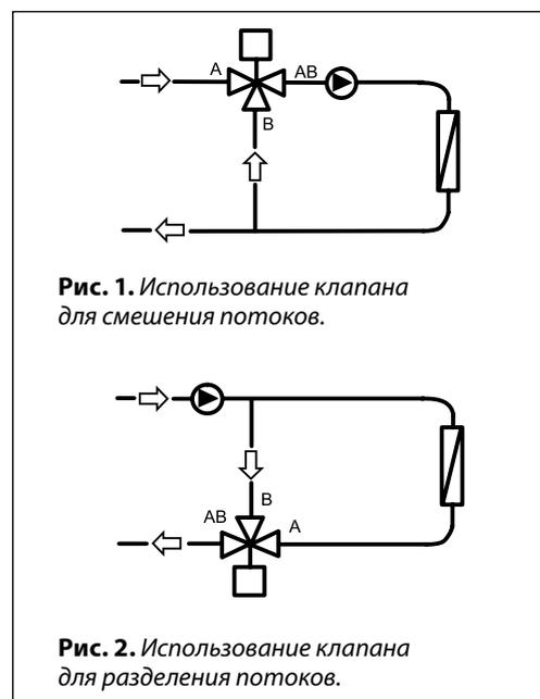
**Рис. 1.** Использование клапана для смешения потоков.
