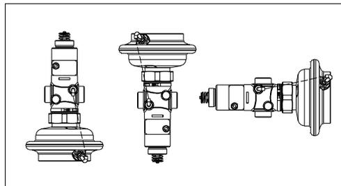
При более высокой температуре клапан следует устанавливать только на горизонтальном трубопроводе диафрагменным элементом вниз.
