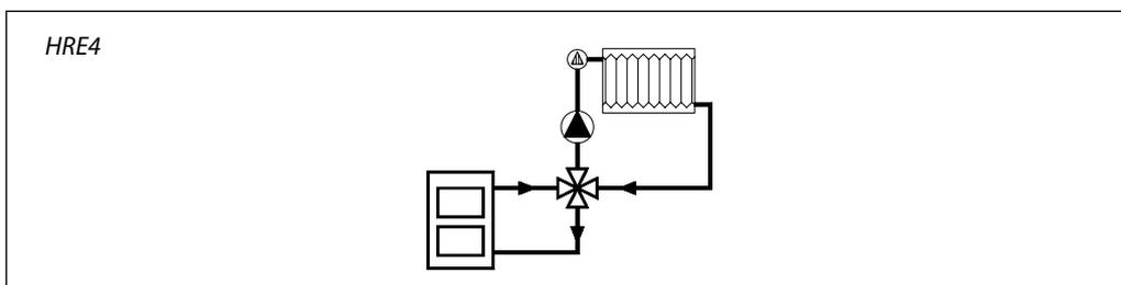
При необходимости реверсирования потоков требуется изменить направление вращения электропривода и положение шкалы индикатора.
