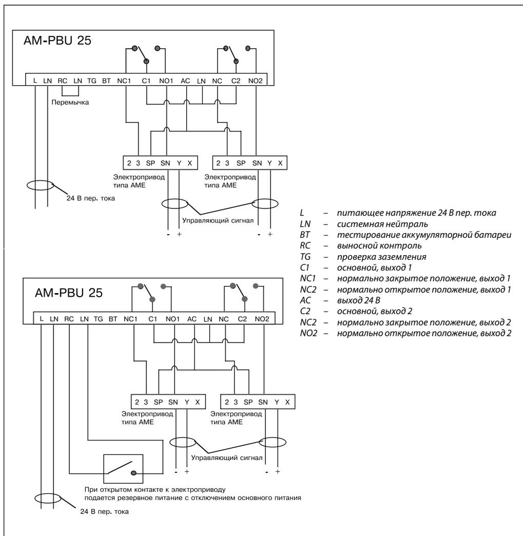
Перемычка между LN и RC может быть заменена подключением к системе диспетчеризации инженерного оборудования зданий (BMS), регулятором или ручным переключателем. Когда контакт разомкнут, подача напряжения от сети отключена (*building mains power*) и агрегат AM-PBU 25 проходит цикл, получая питание от аккумуляторной батареи. Данная функция может использоваться для выносного контроля регулирующего клапана или
