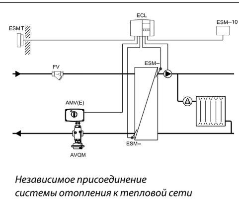
Установка клапана на подающем трубопроводе
