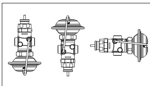
При более высокой температуре клапан следует устанавливать только на горизонтальном трубопроводе диафрагменным элементом вниз.
