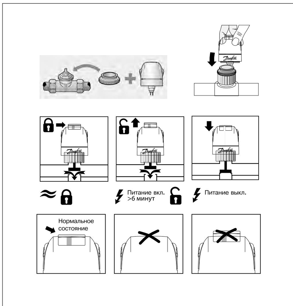
Привод рекомендуется устанавливать на клапане либо горизонтально, либо вертикально сверху. При установке привода в перевернутом положении его надежная работа не гарантируется.
