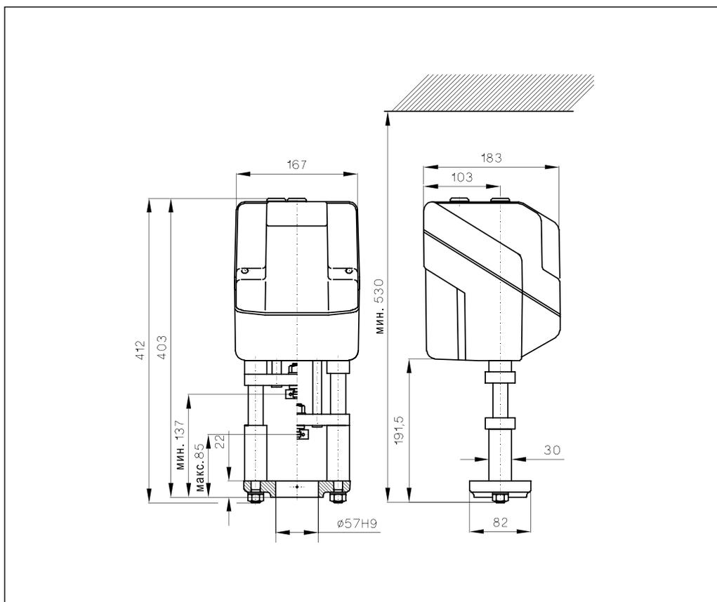
Комбинации электроприводов и регулирующих клапанов
