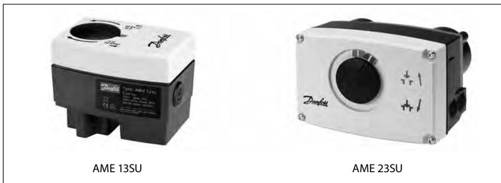
Электроприводы предназначены для управления регулирующими клапанами VZ и VZL (AME 13SU), VS2, VM2 и VB2. Функция безопасности (возвратная пружина) активируется при обесточивании привода или подаче сигнала с термостата защиты. Шток привода пружиной вытягивается. Приводы автоматически подстраивают ход своего штока под ход штока клапана, что снижает время введения клапана в эксплуатацию.
