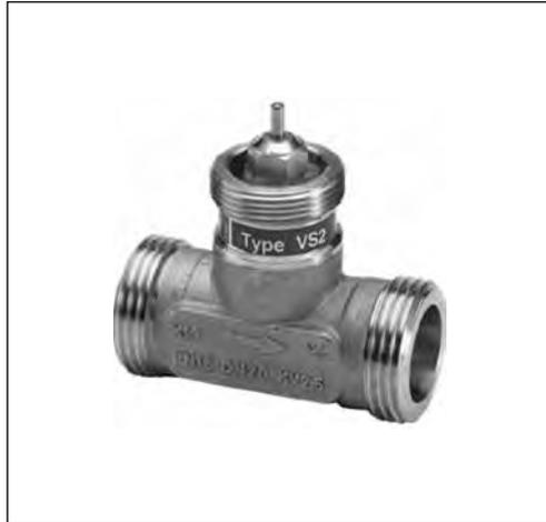
Регулирующий клапан VS2 предназначен для применения с редукторными электрическими приводами AMV 150 ( $D_y = 15$  мм), AMV(E) 10, AMV(E) 20, AMV(E) 30, AMV(E) 13, AMV(E) 13SU, AMV(E) 23, AMV(E) 23SU и AMV(E) 33 преимущественно в системах отопления, горячего водоснабжения, вентиляции и кондиционирования воздуха.
