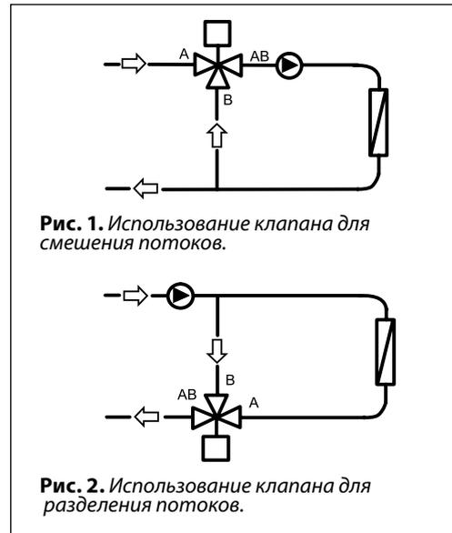
Рис. 1. Использование клапана для смешения потоков.
