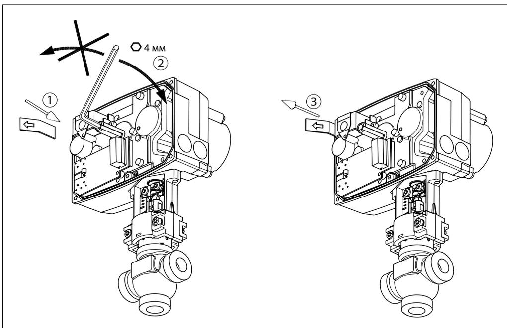
Ручное позиционирование осуществляется при снятой крышке и отключенном питании вращением 4-мм шестигранного торцевого ключа (в комплект поставки не входит), преодолевая усилие пружины. Чтобы удерживать шток привода в требуемом положении, ключ
