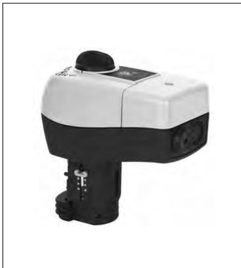
Данный электропривод предназначен для управления двух- и трехходовыми регулирующими клапанами VF3 условным проходом до 80 мм и клапанами серий VRB, VRG. Приводы имеют концевые моментные выключатели, прекращающие их работу при возникновении перегрузок, а также при достижении штоком клапана крайних положений.
