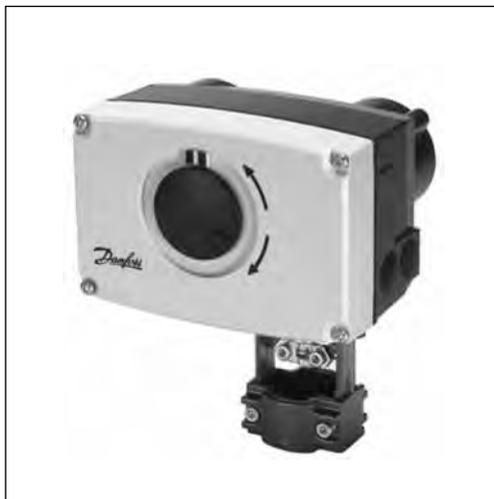
Электроприводы AME 25SD и AME 25SU предназначены для управления регулирующими клапанами VF3 и VF52 с условным проходом до 50 мм включительно. Электропривод автоматически подстраивается под ход штока клапана.
