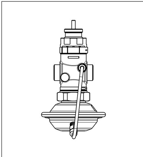
AVQM является комбинацией седельного регулирующего клапана (исполнительного механизма электрической системы регулирования) и автоматического регулятора – ограничителя расхода прямого действия с диафрагмой и рабочей пружиной.
