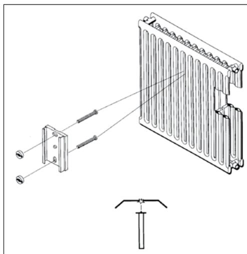
Для приварки шпилек к стальным панельным радиаторам необходим сварочный пистолет ACCU-TWIN.
