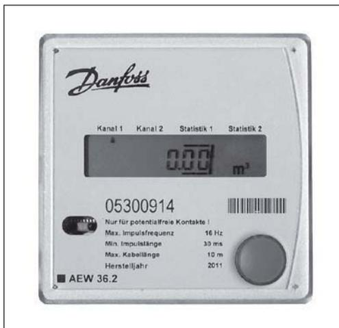
Импульсный адаптер INDIV PAD получает и преобразует импульсы от одного или двух счетчиков потребления энергоресурсов и передает данные в сеть INDIV AMR. Прибор используется в системах учета, где предусмотрена установка счетчиков потребления энергоресурсов с импульсным выходом, с целью сбора данных с этих счетчиков в радиосистему INDIV AMR.
