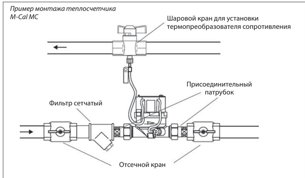
**Монтаж измерительной капсулы в проточную втулку**
