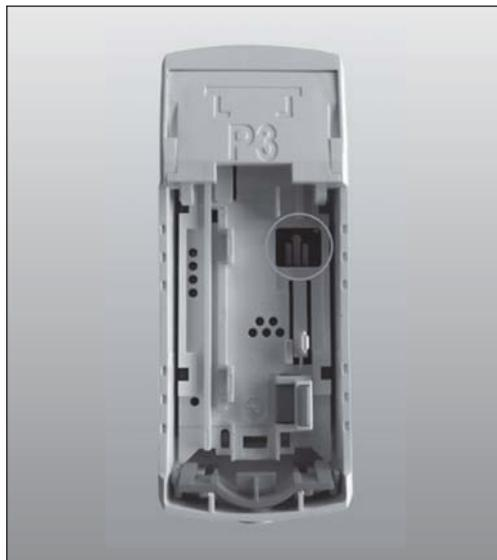
После подключения выносного датчика встроенный датчик счетчика-распределителя деактивируется, и на переменном дисплее в правом нижнем углу появляется символ S. После этого вернуть счетчик-распределитель в режим работы со встроенным датчиком невозможно.
