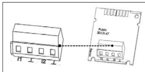
*Модуль импульсного выхода*
