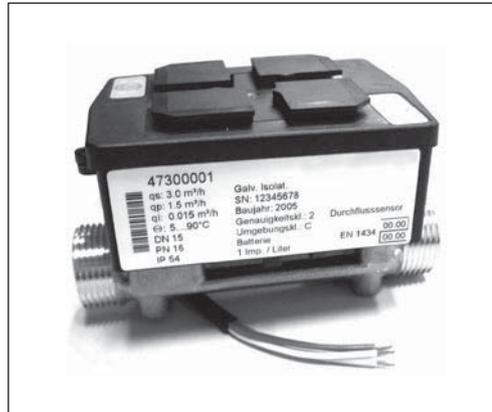
Расходомеры SONO 1500 CT предназначены для измерения расхода воды в системах тепло- (холодо-) и водоснабжения на объектах коммунального хозяйства и других отраслях промышленности при выполнении технологических и учетно-расчетных операций.
