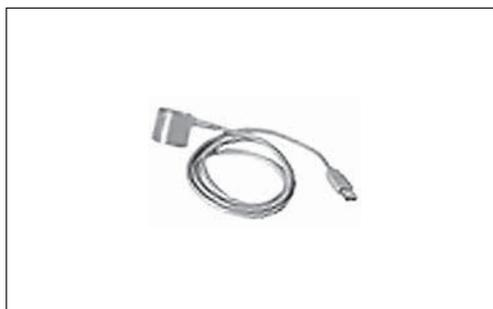
Адаптер АПС 78 служит для подключения переносного накопителя АДС 90 к приборам СПТ 943.1, оснащенным оптическим коммуникационным портом. Подключение накопителя АДС 90 с помощью адаптера АПС 78 к прибору через оптический порт не требует снятия пломб и перевода прибора в незащищенный режим хранения данных. Адаптер представляет собой преобразователь сигналов интерфейса RS 232C в оптические сигналы инфракрасного диапазона и обратно.
