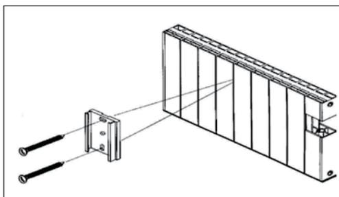
Монтаж на чугунные секционные радиаторы
