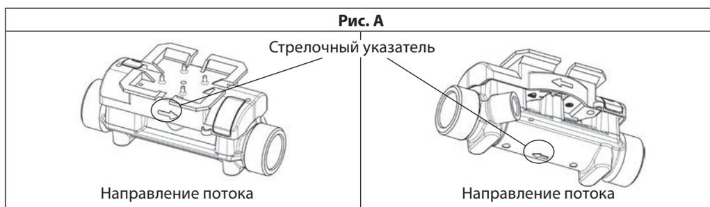
По окончании установки расходомер должен быть постоянно заполнен жидкостью. Установки элементов для гидродинамической стабилизации потока до и после расходомера (прямых участков) не требуется. Теплосчетчик можно устанавливать на вертикальных или го-
