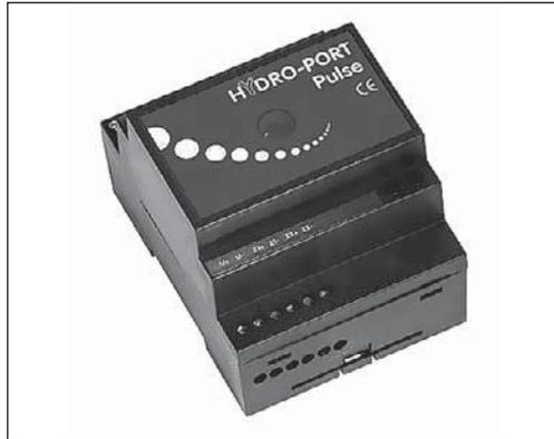
Преобразователь импульсных сигналов Hydro Port Pulse предназначен для подключения к сети M-bus устройств учета ресурсов, обладающих импульсным выходом. Преобразователь импульсных сигналов подключается к M-bus-шине и преобразует импульсные сигналы от счетчиков ресурсов (счетчиков электроэнергии, тепла, воды и прочих) в протокол M-bus. Преобразователь импульсных сигналов имеет два неза-
