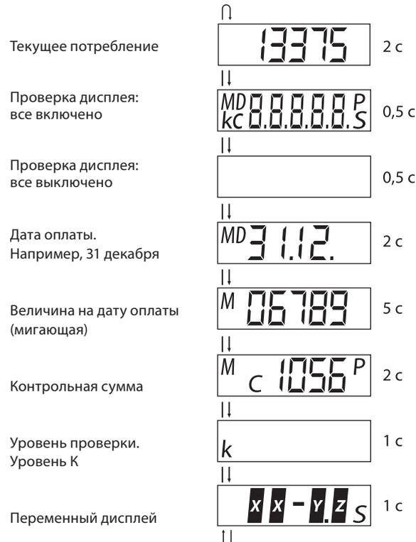
Значения символов X, Y, Z на переменном дисплее в активном режиме аналогичны значениям в «спящем» режиме. Счетчик-распределитель INDIV-5R снабжен встроенным радиопередатчиком, который обеспечивает беспроводную передачу данных в домовую радиосеть системы INDIV AMR (см. раздел «Система учета теплотребления INDIV AMR с автоматизированным сбором и передачей показаний с распределителей INDIV-5R и других приборов учета энергоресурсов»).
