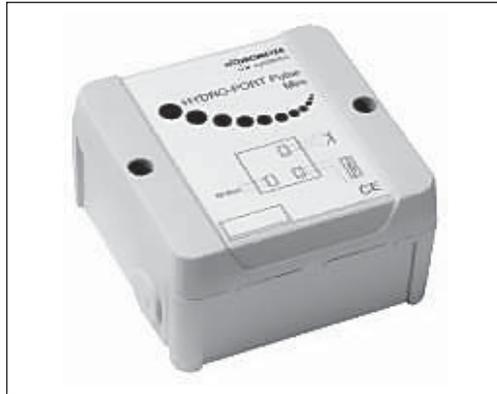
Преобразователь импульсных сигналов Izar Port Pulse Mini предназначен для подключения к сети M-bus устройств учета ресурсов, обладающих импульсным выходом. Преобразователь импульсных сигналов подключается к M-bus-шине и преобразует импульсные сигналы от счетчиков ресурсов (теплосчетчиков, счетчиков воды, электроэнергии и др.) в протокол M-bus. Преобразователь импульсных сигналов Izar Port
